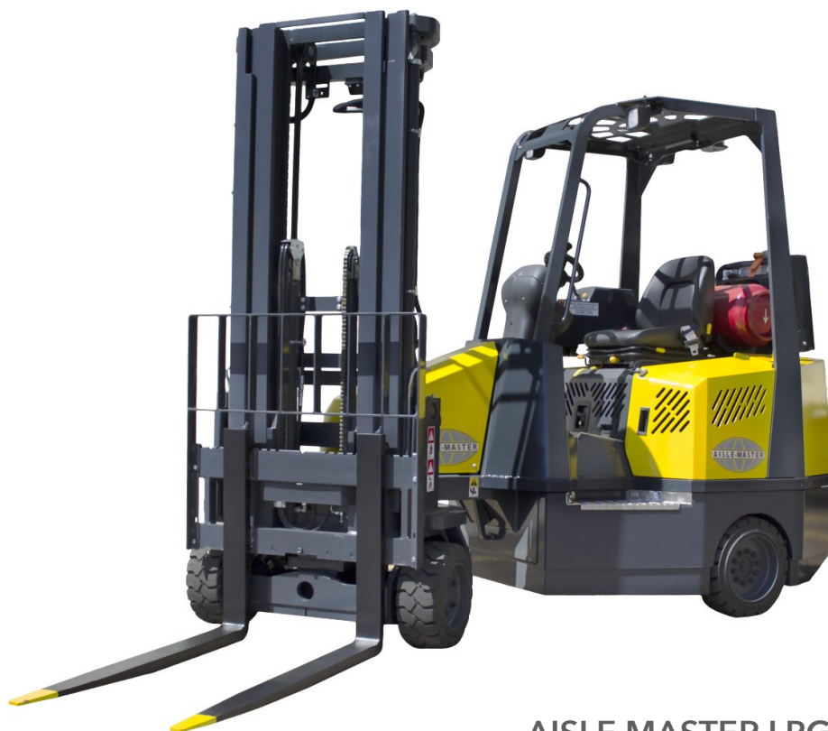
AISLE MASTER LPG GAS LICUADO DE PETRÓLEO [CAPACIDAD 2,000 KG]
